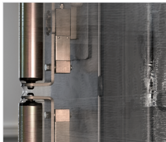
Corner test Anlegespannung Palettenkanten
