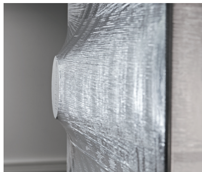
Elastic recovery Rückstellkraft nach ASTM D4649-03
