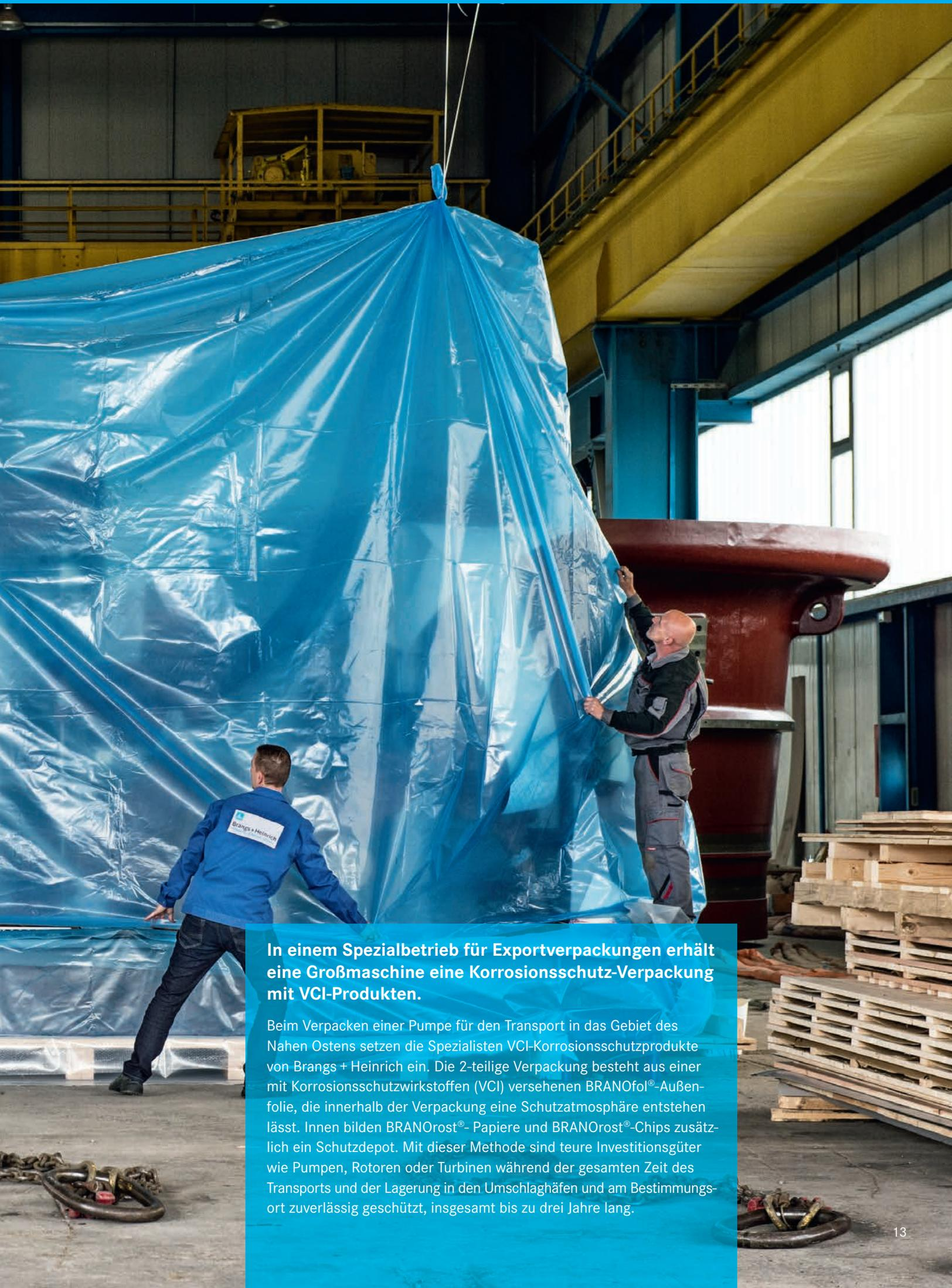
**In einem Spezialbetrieb für Exportverpackungen erhält eine Großmaschine eine Korrosionsschutz-Verpackung mit VCI-Produkten.**
